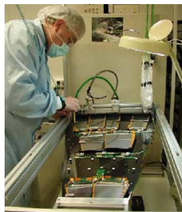
fig. 6, 7 et 8 : le détecteur de traces de CMS, partiellement assemblé en Belgique.
