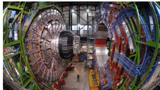
fig.4.: le détecteur CMS en cours d'assemblage.
